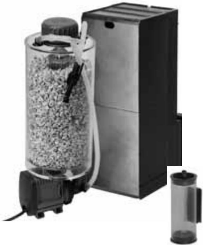
Nel TUNZE® Calcium Automat 3170 l'acqua arricchita di anidride carbonica scorre, spinta da una pompa, attraverso il granulato per l'aumento della durezza. L'anidride carbonica gassosa reagisce con l'acqua trasformandosi in acido carbonico e dalla roccia calcarea discioglie l'idrogenocarbonato di calcio. L'acqua così indurita esce dal reattore attraverso un rubinetto di regolazione.
