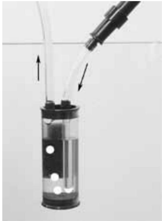
**Problema:** la CO<sub>2</sub> non passa attraverso il contabillicine nonostante l'apertura della valvola di regolazione fine sul riduttore di pressione.
