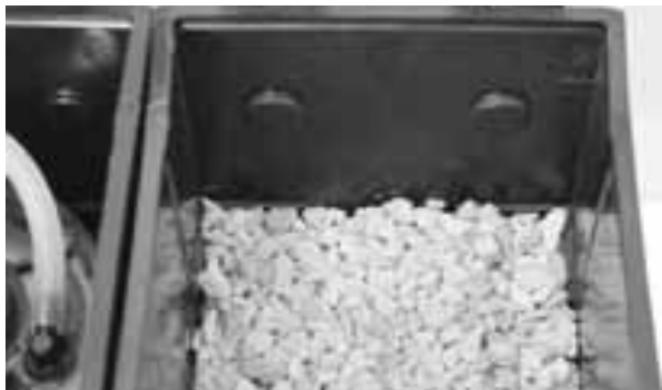
Se si impiega l'Extension 3170.50 controllare ed eventualmente integrare la sua quantità di granulato. La quantità di granulato non dovrebbe scendere sotto l'80% della capacità massima (3).
