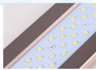
Светодиоды на плате расположены в шахматном порядке
