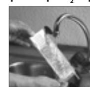
1. Реактор CO<sub>2</sub> Flipper ополосните тёплой водопроводной водой. Не применяйте никаких чистящих средств!
