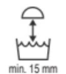
Symbolet gjør oppmerksom på at avstanden fra lampens underside til høyeste vannivå må være minst 15 mm.
