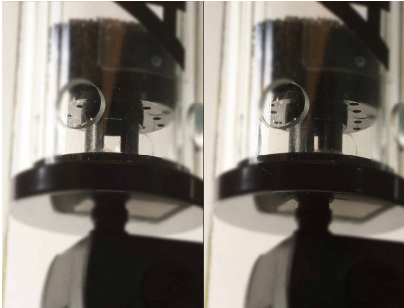
Foto 2: Regelen van de stroomsnelheid door het verhogen of verlagen van de spleetbreedte in de reactor door de hendel van het apparaat te verdraaien. De pomp wordt eenvoudig aangesloten van onderen. Dit is verstelbaar.
