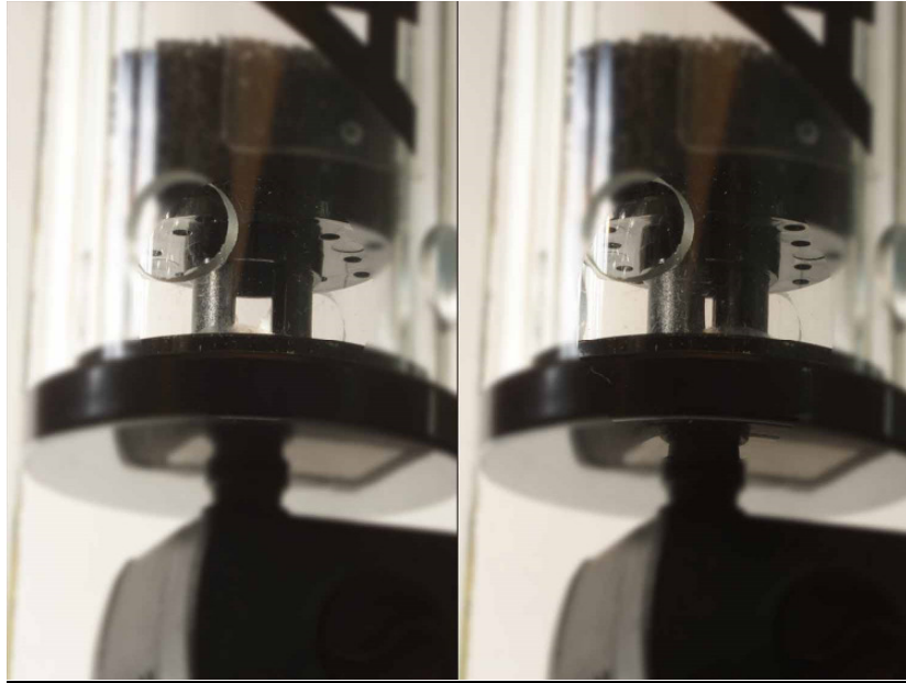
Rys. 2: Przepływ reguluje się przez zmianę szerokości przerwy wewnątrz reaktora. Regulacji dokonuje się przekręcając pokrętkę na górze reaktora. Pompa jest podłączona na dole i także można regulować jej wydajność.
