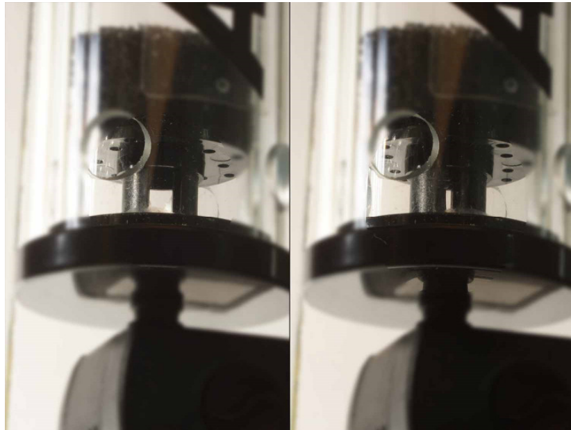
Foto 2: Die Regulierung der Durchflussmenge erfolgt durch Änderung der Spaltbreite im Reaktor, indem man den Knauf oben am Gerät verdreht. Die Pumpe wird von unten einfach aufgesteckt. Auch diese ist regelbar.
