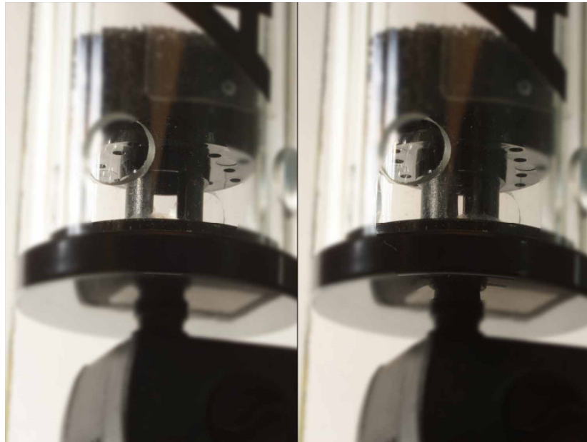
Фото 2: Управление протоком происходит вращением кнопки сверху реактора. С её помощью изменяется размер щели, через которую проходит вода. Помпа просто надевается снизу реактора. Её также можно настраивать.
