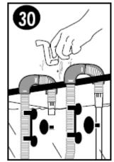
Энергично прокачайте несколько раз заливочное устройство (Т) для пуска насоса при атмосферном давлении (полностью используйте длину хода вверх и вниз). Продолжайте прокачку до тех пор,
