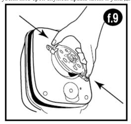
Для доступа к крыльчатке снимите крышку крыльчатки путем нажатия двух язычков (f9). При необходимости следует очистить магнитную крыльчатку. Для извлечения ее осторожно возьмитесь за рабочее колесо, выньте его из камеры и промойте чистой водой. Проверьте, чтобы камера крыльчатки была чистой. Если требуется, используйте для этого чистящую щетку Fluval. Затем вставьте крыльчатку обратно.
