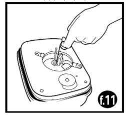
Для установки узла керамического вала обратно необходимо поместить магнитную крыльчатку (Ц) на узел керамического вала, вставить их в камеру крыльчатки и осторожно нажать на вентилятор крыльчатки для стопорения их на месте.
