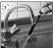
• Острие электрода ополосните водопроводной водой, чтобы удалить с него KCL-раствор (2)
