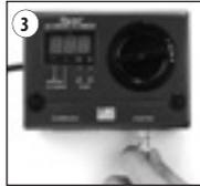
• Подсоедините BNC-коннектор к pH-Контроллеру или иному измерительному прибору (3)
