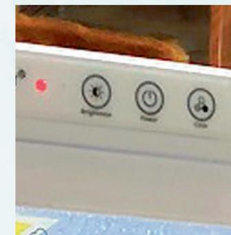
Сенсорная панель управления на передней стенке крышки
