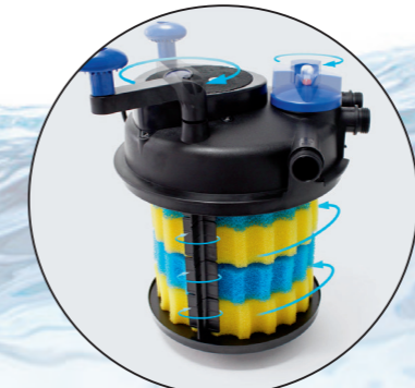
Принцип работы фильтра в режиме самоочистки: обратная промывка и отжим губок с помощью ручки и отжимного вала
