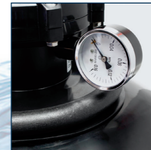
Контрольный манометр. Давление в фильтре не должно превышать 0,3 Бар. При превышении необходимо провести очистку
