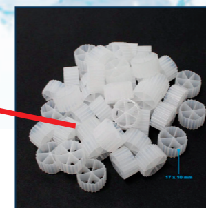
Внутренний объём фильтра заполнен биоэлементами 17x10 мм из нейтрального пластика с развитой поверхностью ок. 1000 м²/м³
