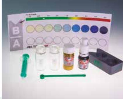
Для постоянного отслеживания параметров воды JBL предлагает линейку тестов. В большинстве из них требуется добавить реагент, чтобы вода изменила окраску. Тесты JBL обладают замечательной особенностью, которая позволяет определять измеренные значения просто и чрезвычайно аккуратно: вместо сравнения только изме-
