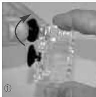
Шланг, подающий CO<sub>2</sub>, с внешним диаметром 6 мм отрежьте ровно и вставьте в нижнюю часть реактора. Конец шланга должен лежать на упоре. (2)
