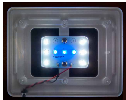
6 белых и 3 синих светодиода
